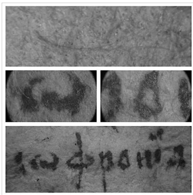
Фиг. 9. Наблюдение под микроскоп на хартията и мастилото на подписа на Софроний Врачански. Снимките са направени с микроскоп при увеличение 50х. Фотография Никифор Харалампиев
