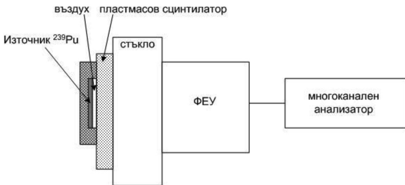
Фиг. 1. Схема на експерименталната система, с която са получени алфа-спектрите
